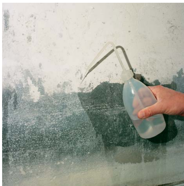
Ścianę wystarczająco dobrze odolejono. Woda, (rozpylona tutaj w celach demonstracyjnych), wnika trochę w głąb i nie perli się od razu.
